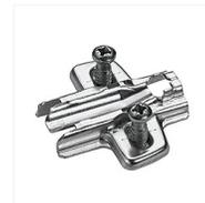
Embase cruciforme à visser Harpe II, avec vis prémontées, entraxe 32 mm
